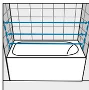
Die Maße von der Wand bis zum Außenrand der Wanne ermitteln. Die Messung ist bei fertiggestellter Wand und verlegtem Fußboden nach den angeführten Schema vorzunehmen.
